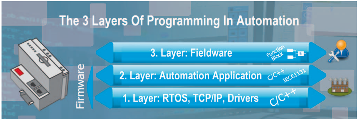
Die drei Ebenen der Programmierung von Automationssystemen
